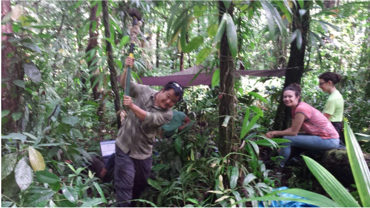
Figure 15 : Abattage du marteau pour générer l'onde sismique pour l'enregistrement du profil de sismique réflexion P9 en aval du knickpoint. Quatre profils sismiques ont été réalisés entre le 28 mai et le 5 juin 2019.
