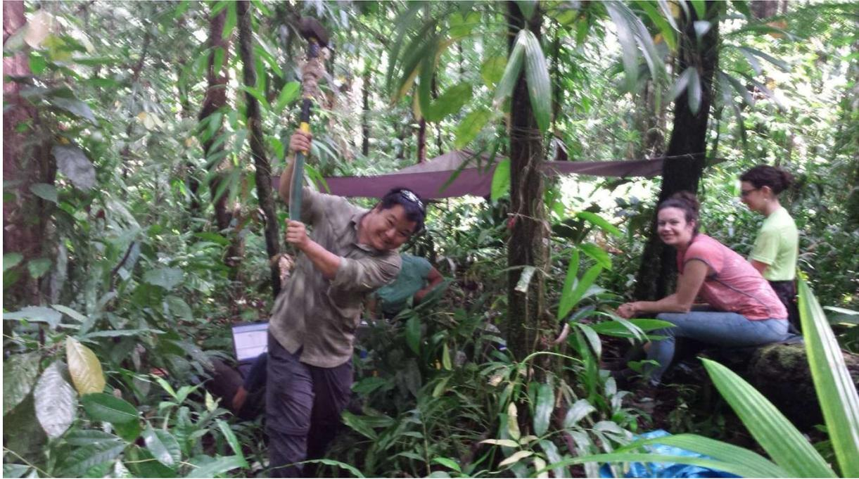
Figure 15 : Abattage du marteau pour générer l'onde sismique pour l'enregistrement du profil de sismique réflexion P9 en aval du knickpoint. Quatre profils sismiques ont été réalisés entre le 28 mai et le 5 juin 2019.
