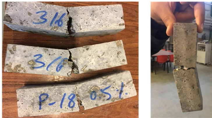
Figure 7: Rupture des échantillons de mortier avec l'incorporation d'intissé en tant que morceaux
