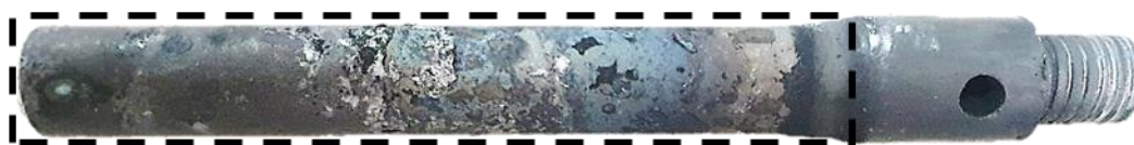
Figure V- 18 : photo de l'anode en carbone après électrolyse.
