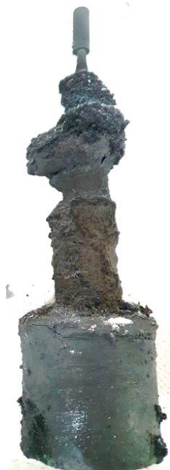
Figure V- 13 : Photo de la cathode et du récupérateur de métal après électrolyse de \text{LiF-NdF}_3\text{-Nd}_2\text{O}_3 (4,0 %mass.), I = 3,5 \text{ A} , S = 0,88 \text{ cm}^2 , t = 24 \text{ h} , T = 1050 \text{ }^\circ\text{C} .
