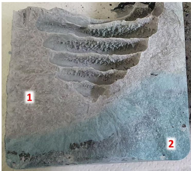
Figure V- 19 : vue en coupe du mélange \text{LiF-NdF}_3\text{-Nd}_2\text{O}_3 recristallisé après électrolyse. 1 : Sel recristallisé, 2 : boues denses riches en oxyde
