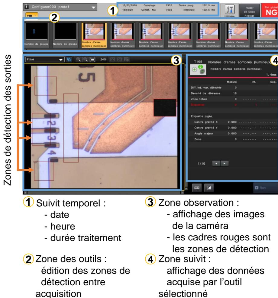
Figure.106 : Interface du système CVX et zones de détections pour notre microsysteme. 6 zones sont configurées : une pour chaque sortie, une en entrée et une avant les sorties.
