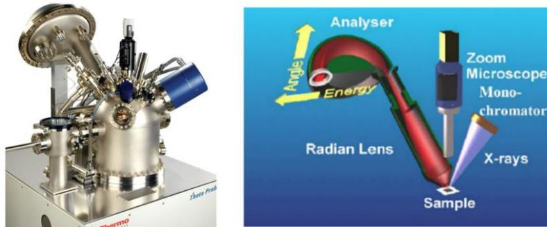
Figure 37 : Équipement Theta300™ [Thermofisher a].
