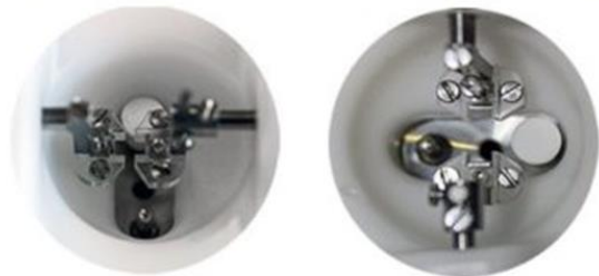
Figure 37 Images d'un myographe EMKA technologies et zoom sur les mâchoires où les vaisseaux sont positionnés
