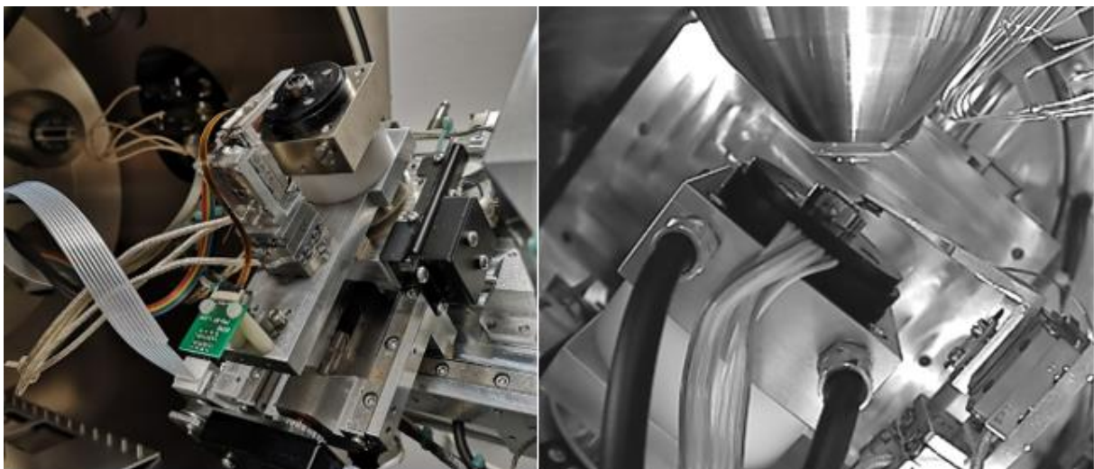
Figure 74 – Nanotensiomètre présenté dans la chambre de l'ESEM, à gauche la porte de l'ESEM ouverte, à droite la porte fermée.
