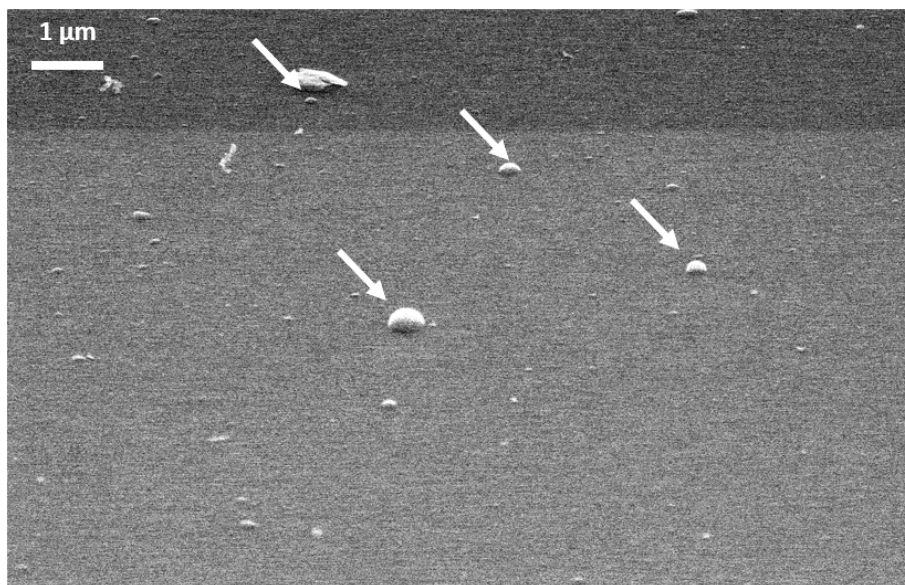
Figure 50 - Exemple goutte d'eau condensant sur des particules atmosphériques, image obtenue par ESEM.
