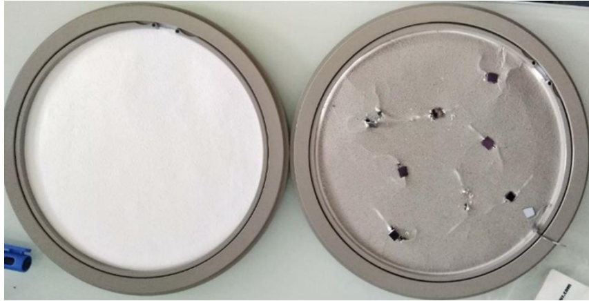
Figure 16 - Filtre de 150 mm de diamètre pour collecte de particules fines, à gauche un filtre vierge avant collection, à droite un filtre avec des wafers de silicium greffés après collection.
