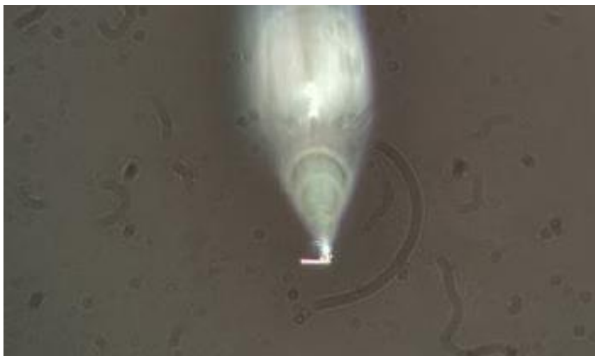
Figure 71 - Levier piézorésistif avec un nanofil d'or collé en bout de levier, image capturée à l'aide d'un téléphone.
