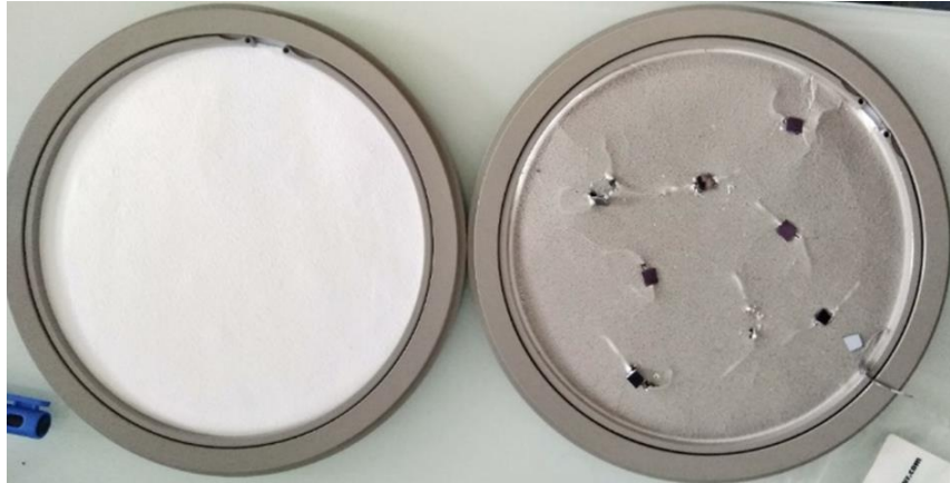
Figure 16 - Filtre de 150 mm de diamètre pour collecte de particules fines, à gauche un filtre vierge avant collection, à droite un filtre avec des wafers de silicium greffés après collection.
