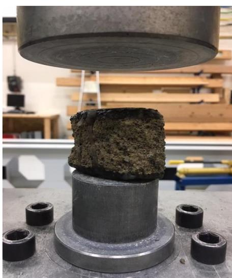
Figure 71. Photographie du conglomérat avant le test de résistance à la compression.
