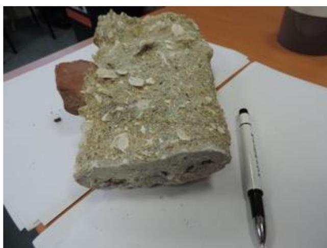
Figure 27. Photographie d'un conglomérat formé à partir du procédé Géocorail®.
