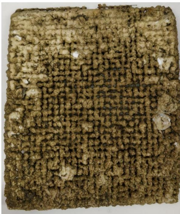
*Figure 8. Photographie de dépôt calcomagnésien sur une grille métallique, formé en eau de mer naturelle.*
