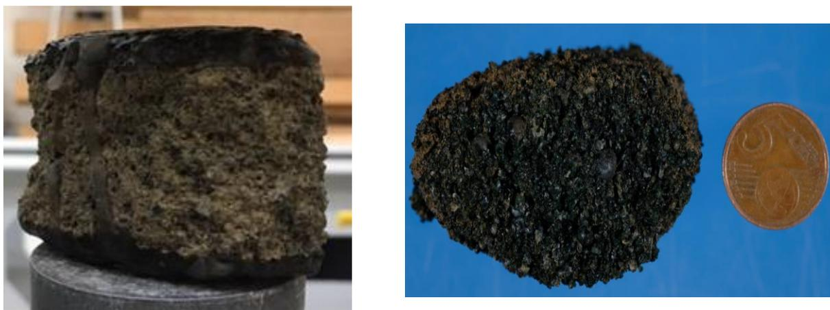
Figure 68. Photographie du conglomérat de scories agglomérées collecté dans le port de Nouméa.
