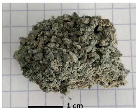
Figure 64. Photographie d'un bloc de scories indurées après 7 mois de vieillissement in-situ.
