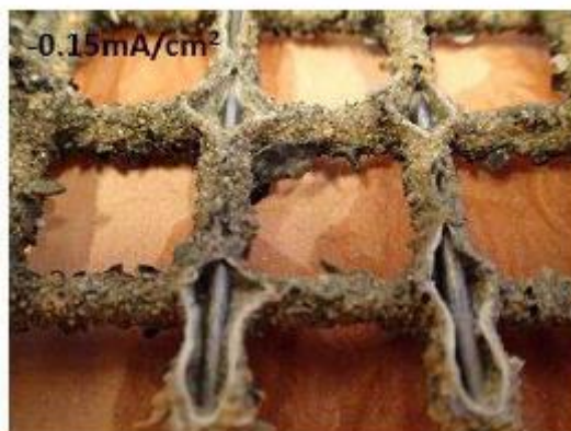
Figure 26. Photographie d'une grille polarisée à -150 \mu\text{A}/\text{cm}^2 présentant une zone de vide entre la grille et le dépôt (Crédit : A. Zanibellato).
