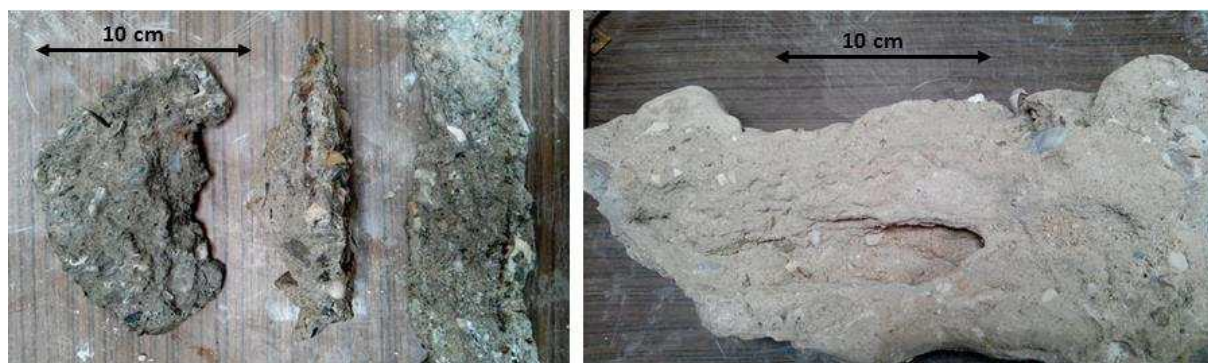
Figure 9. Photographies de blocs de Géocorail® formés sur les sites de Belle-Île (gauche) et sur l'île de Ré (droite). (Crédit : A. Zanibellato)
