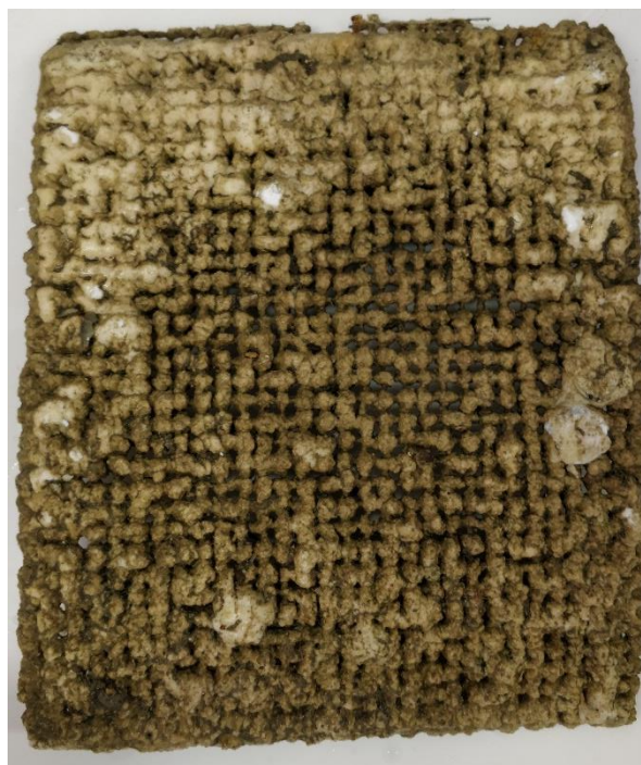
Figure 8. Photographie de dépôt calcomagnésien sur une grille métallique, formé en eau de mer naturelle.
