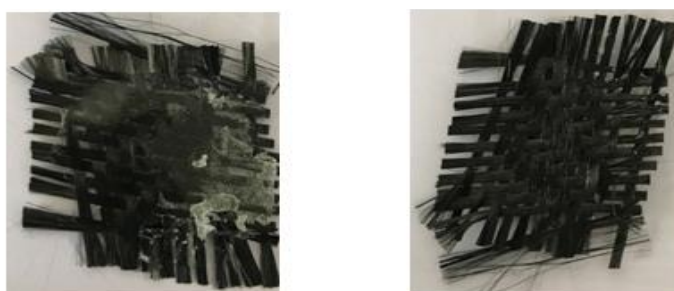
Figure 5 : Renfort : une couche de fibres de carbone ; matrice : V 70WS/TRIS/BAPO/S938 (90%/10%/3%/2% w/w/w/w). Vitesse de passage : 2 m/min. Irradiation avec un convoyeur UV (lampe Hg-Fe) ( I = 850 \text{ mW/cm}^2 ).
