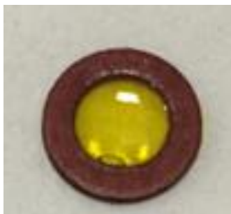
Figure 3 : Polymère obtenu pour le système HDDA/Eb8402/UVACURE1500/S938/NZ20 (24,5%/24,5%/49%/1%/1% w/w/w/w/w) après 400 sec d'irradiation à 405 nm.
