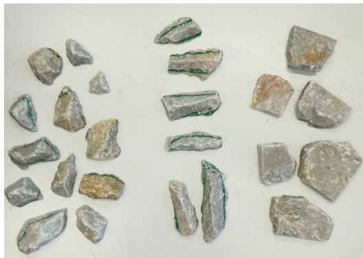
FIGURE 3.6 – Exemple de morceaux de roches utilisés en tant que sommet (à gauche), arêtes (au centre) et plans (à droite).
