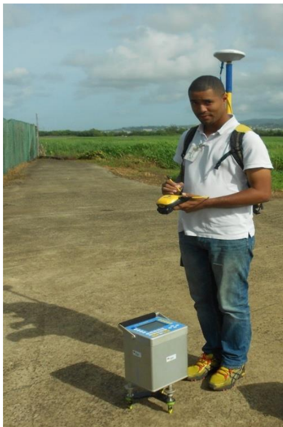
Figure 36: Mesure de l'accélération de la pesanteur à l'aide du gravimètre (appareil au premier plan) et acquisition des données de localisation par DGPS.
