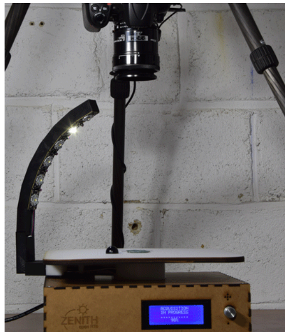
Figure 2.3 – Système RTI du laboratoire NIMBE par Mickaël Bouhier et Jean-Charles Méaudre
