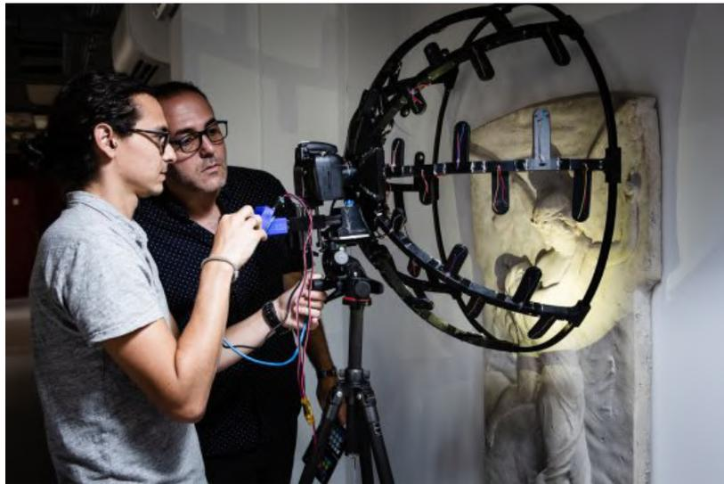
Figure 2.2 – Expérimentation d'un prototype de dôme RTI - ©Frédérique PLAS / MAP / CNRS Photothèque
