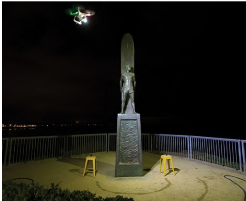
Figure 2.5 – Acquisition RTI sur la statue commémorative du surfeur à Santa Cruz, en Californie, en pilotant un drone transportant une source d'éclairage, de [Fowler 20]
