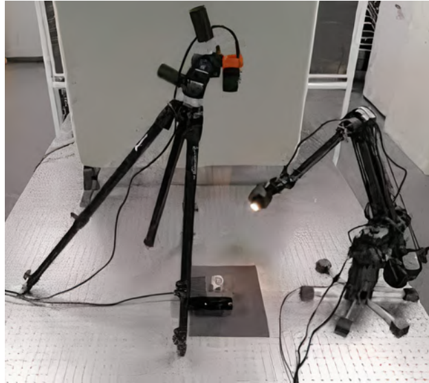
Figure 2.4 – Un système RTI se composant d'un bras robotisé qui tient une source d'éclairage, un plateau tournant sur lequel est posée la surface et une caméra multispectrale, de [Kitanovski 21]
