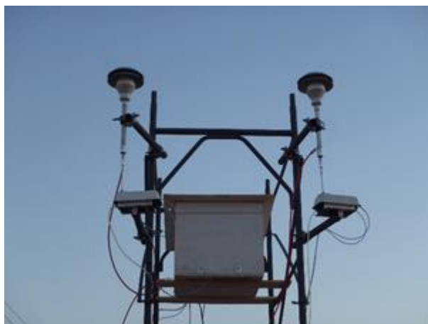
Figure 3.6 : Les deux Welas® (7218 et 7215) en position d'inter-comparaison (©J. L. Rajot). Noter les têtes de prélèvement TSP adaptées aux instruments.
