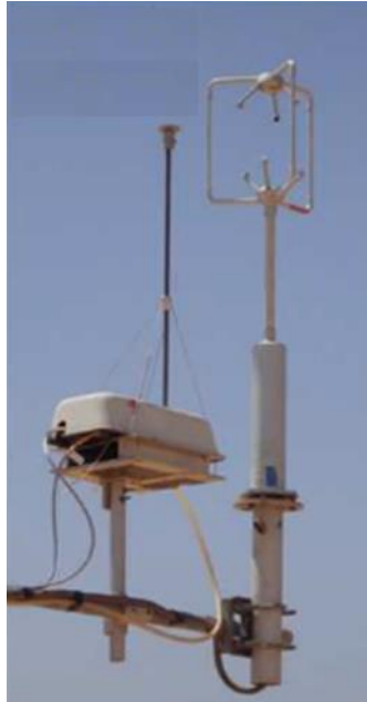
Figure 4.9 : Dispositif de mesure des flux par la méthode EC : Welas ® INRA équipé d'une tête de prélèvement de faible encombrement (instrument de gauche) et anémomètre sonique 3D (instrument de droite). (©S. Dupont)
