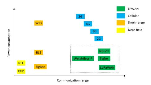
Figure 1 – Consommation d'énergie en fonction de la portée de communication pour divers protocoles radio, comme illustré dans [5].
