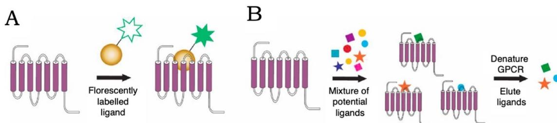
**Figure 11. Tests *in vitro* de HTS sur des RCPG.** (A) Essais basés sur des ligands marqués par un fluorophore activé lors de la liaison du ligand au récepteur. (B) Essais basés sur la spectrométrie de masse par affinité, où le RCPG est incubé avec des centaines de ligands potentiels. Les ligands liés au RCPG vont être élués et analysés par chromatographie liquide/spectrométrie de masse. Figure modifiée d'après<sup>51</sup>.
