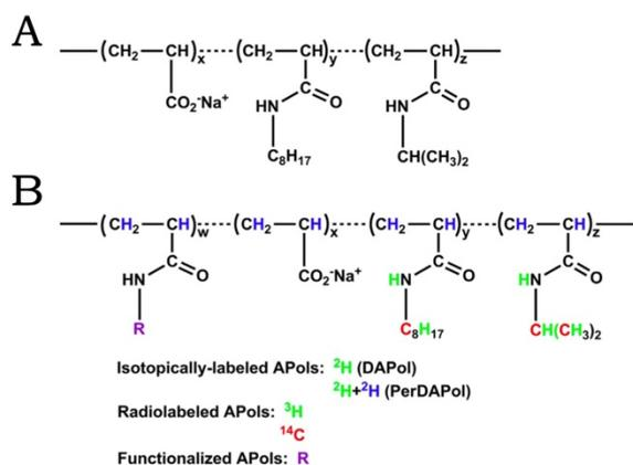
**Figure 20. Représentation schématique de l'amphipol A8-35 et de ses dérivés.** (A) Représentation de l'A8-35 composé de trois groupes différents répartis au hasard le long de la chaîne. (B) Dérivés de l'APol basés sur la même structure chimique<sup>180</sup>.
