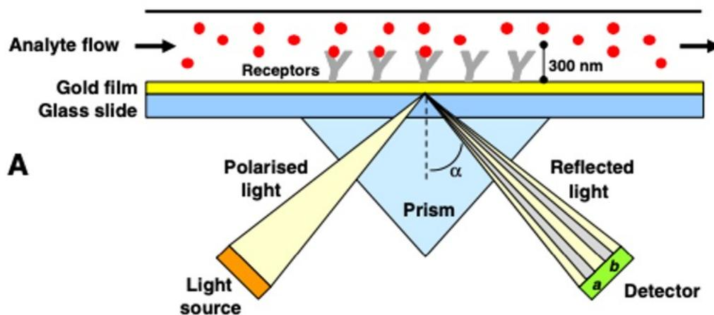
**Figure 17. Principe de la SPR.** La fixation d'un analyte (plus communément appelé ligand pour les biochimistes) sur la protéine immobilisée va induire un changement de masse mesuré par une différence dans l'angle de réfraction de la lumière<sup>126</sup>.
