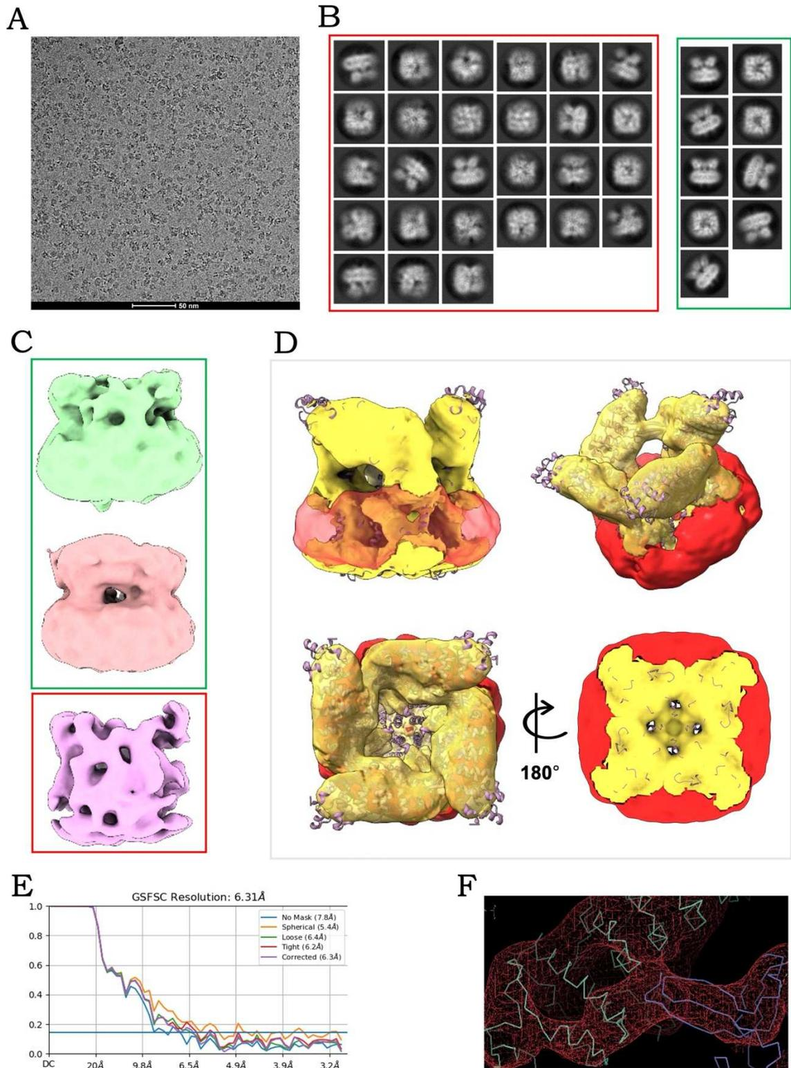
**Figure 50. Cryo-microscopie électronique sur le canal TRPV4 purifié en détergent.** (A) Micrographe de cryo-EM. (B) Classes 2D. En rouge les classes non retenus pour la reconstruction 3D et en vert les classes sélectionnées. (C) Classes 3D. En vert, les classes servant à la reconstruction finale, en rouge les classes écartées. (D) Différentes orientations du volume 3D final. (E) Courbes de corrélation de Fourier. (F) Interaction entre deux domaines ankyrines.
