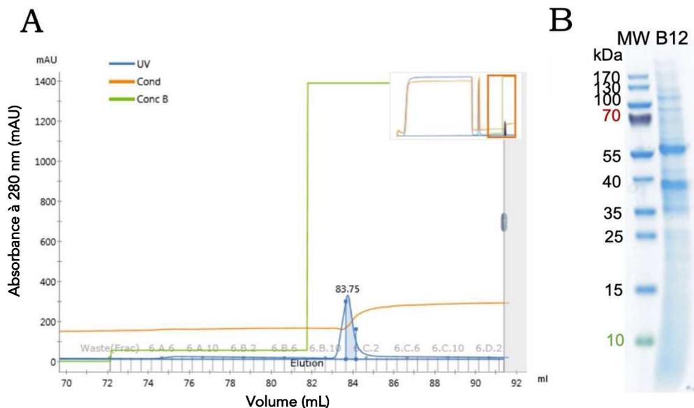
**Figure 34. Purification de  $A_2A\_MP2$  avec le SMA 3000.** (A) Purification IMAC sur une colonne HisTrapHP 1mL. Les protéines sont éluées par un palier à 100 % de tampon B (500 mM). (B) SDS PAGE coloré au bleu de Coomassie de la fraction B12 issue de l'IMAC. MW : marqueur de poids moléculaire.
