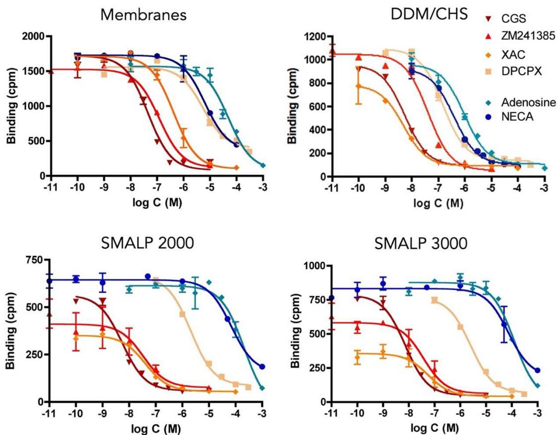
Figure 42. Caractérisation pharmacologique du récepteur  $A_2A\_MP2$  par des tests de compétition. Courbes de compétition entre 10 nM de  $[^3H]$ -ZM241385 et des concentrations croissantes de différents ligands froids. Différents systèmes membranaires ou mimétique de membranes sont évalués.
