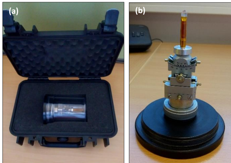
Figure II.34. a) Valise de transport des échantillons pour synchrotron et b) porte-échantillon à double confinement Kapton utilisé sur la ligne MARS monté sur sa tête goniométrique.
