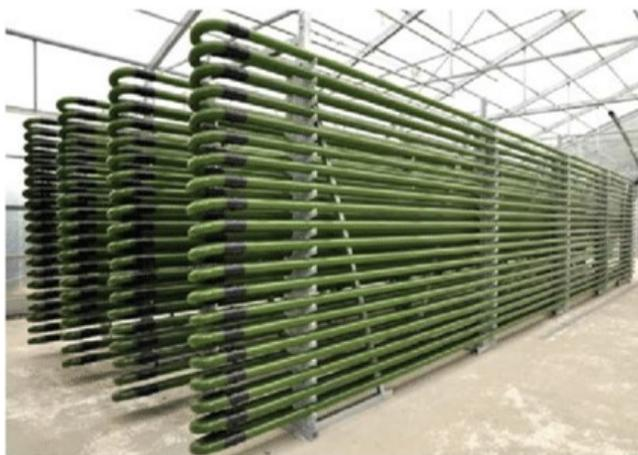
FIGURE 2.3.1 – Photo-bioréacteur tubulaire pour la production d'algues [44]
