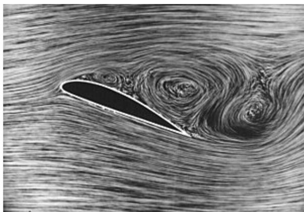
**Figure 2.13.:** Illustration du phénomène de décrochage [20]
