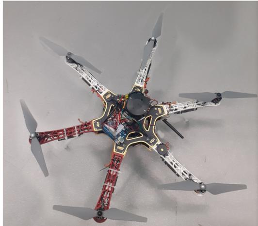
**Figure 5.2.:** Hexacoptère utilisé pour les vols d'essais
