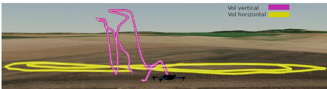
**Figure 3.7.:** Illustration du chemin réalisé lors d'un vol d'essai en phases distinctes pour permettre le découplage des équations
