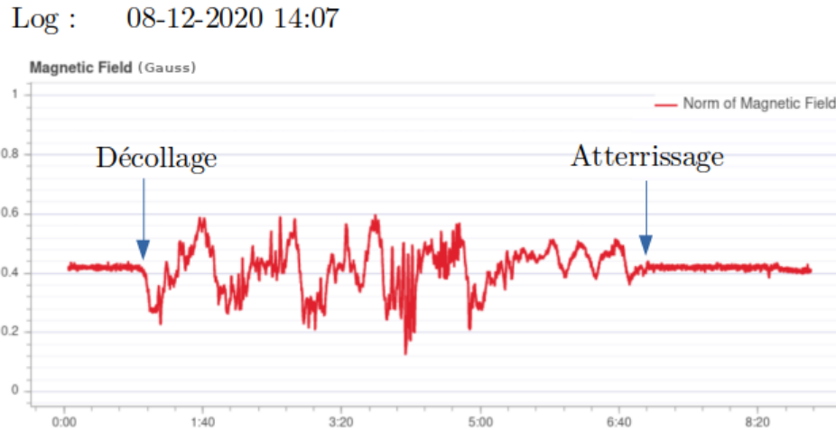
Figure 5.9.: Analyse de la norme du champ magnétique pendant un vol d'essai Remarque: L'appareil est représenté par une image de quadricoptère car le logiciel d'analyse de logs [82] détecte un Firmware de type VTOL.
