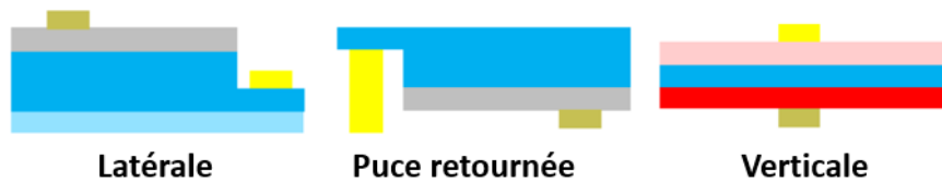
Figure I-15 : Représentation simplifiée des différentes structures micro-LED [49].
