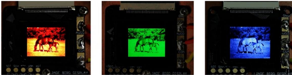
Figure I-20 Micro-écrans monochromes basés sur le procédé monolithique développé par JBD.
