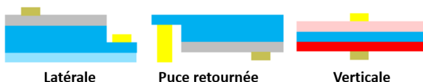
Figure I-15 : Représentation simplifiée des différentes structures micro-LED [49].
