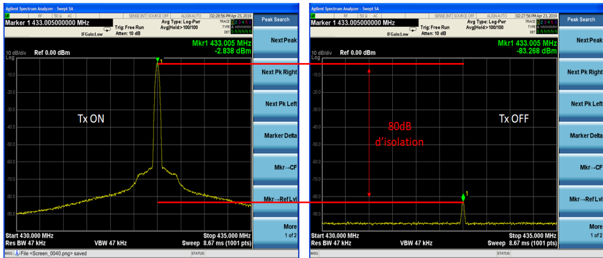
Figure 78: Isolation obtenue à l'aide d'un système fonctionnant en régime pulsé (avec switch TX/RX)
