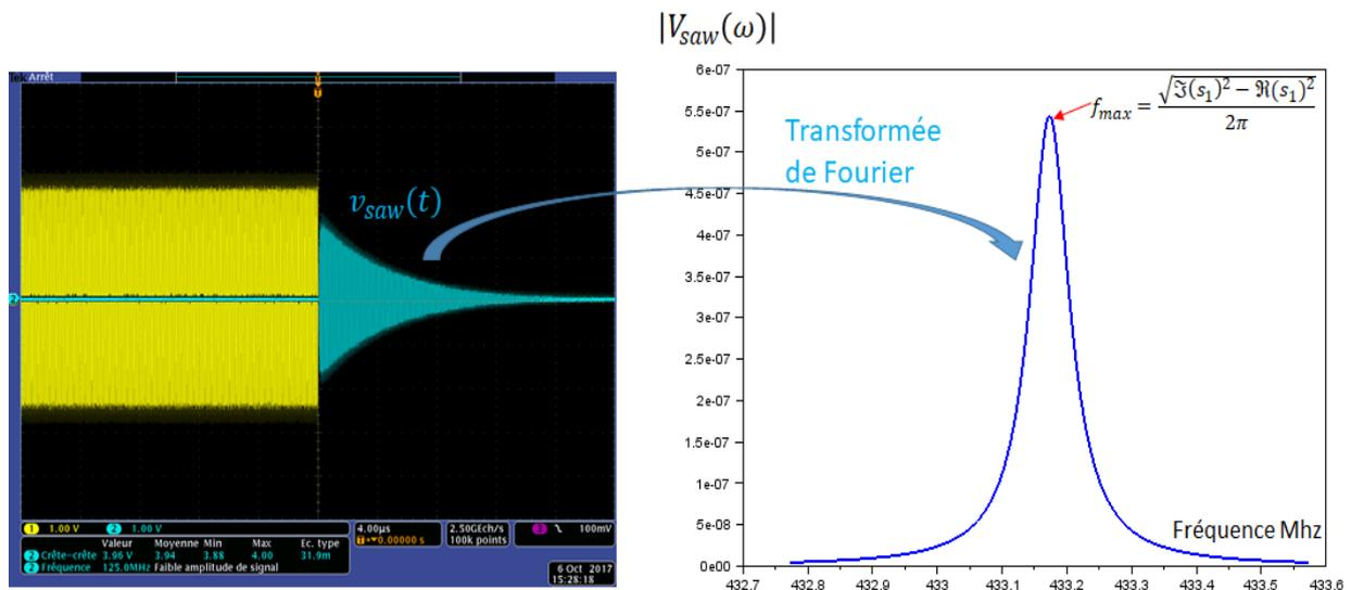
Figure 79: Oscillation amortie  $v_{saw}(t)$  et module de sa transformée de Fourier  $|V_{saw}(\omega)|$
