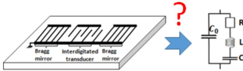
**Figure 58 : Passage des paramètres S au circuit équivalent de type BVD**
