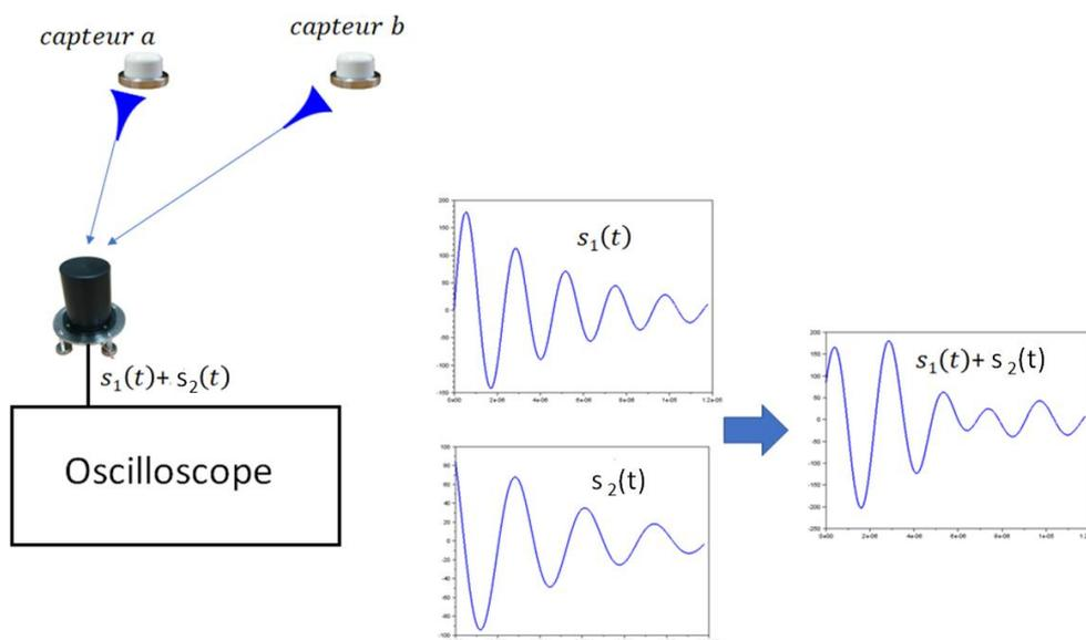
Figure 115: Visualisation des décharges individuelles des deux capteurs et de leur superposition temporelle
