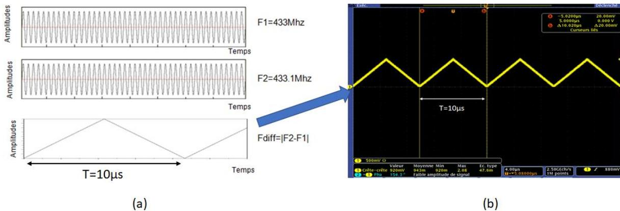
**Figure 88:** (a) signaux d'entrée et différence de phase simulée en sortie du composant AD8302, (b) mesure à l'aide du comparateur de phase
