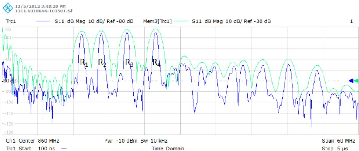
**Figure 38 : Réponse dans le domaine temporel de la ligne à retard à 856 MHz constituée de quatre réflecteurs calculés sur la base de la mesure du  $S_{11}$  dans une bande de fréquence de 60 MHz (en bleu) et dans une bande de 15 MHz (en vert)**
