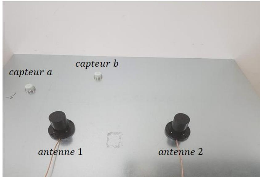
Figure 122: Configuration pour la mesure des capteurs a et b
