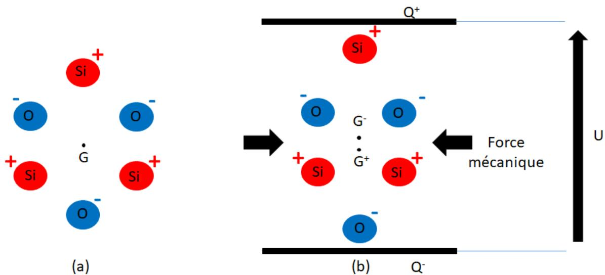
**Figure 10 : (a) représentation schématique d'une maille du cristal de quartz en l'absence de contrainte ; (b) représentation de l'effet piézoélectrique direct : une compression de la maille crée une tension électrique**
