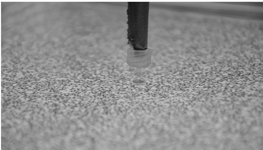
Fig. V.1 Injection de la solution de tensioactif à la surface de l'eau ultra-pure. Nous avons placé sous la cuve un motif de points noirs aléatoires permettant d'observer l'écoulement sans traceurs. Ce motif permet de mesurer la déformation de la surface de l'eau par l'écoulement grâce à la méthode de Free Surface Synthetic Schlieren [100].
