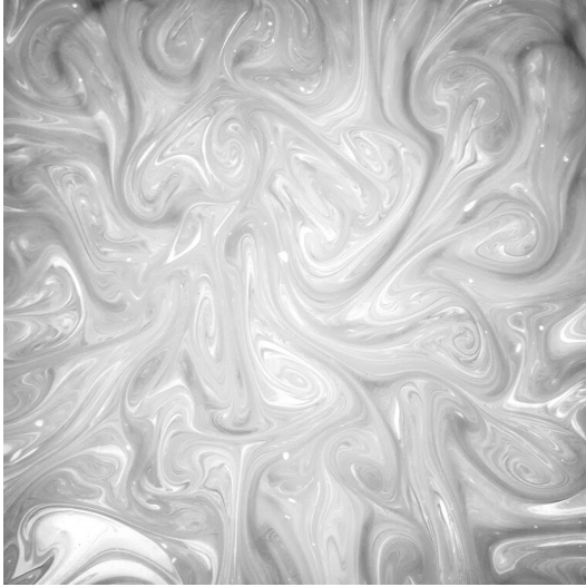
Fig. V.7 Surface saturée en émulsion de tensioactif et d'huile d'olive à la fin des expériences. La trace des tourbillons qui ont été émis reste.
