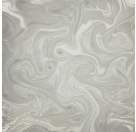
Fig. V.7 Surface saturée en émulsion de tensioactif et d'huile d'olive à la fin des expériences. La trace des tourbillons qui ont été émis reste.
