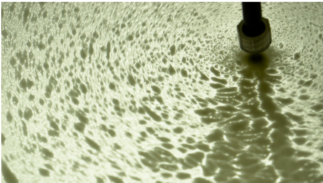
Fig. V.2 Injection de l'émulsion de tensioactif à la fin d'une expérience. La surface de l'eau est saturée par l'émulsion et l'écoulement de marangoni n'existe plus.
