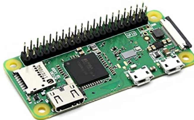
FIGURE 4.21 – Unité de traitement : Raspberry PI Zero
