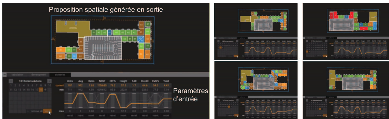
FIGURE 4.2 – Exemple d’agencements spatiaux générés automatiquement grâce aux pratiques des generativ design.
