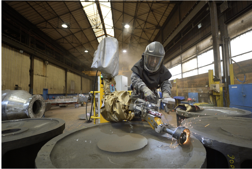
FIG. 1.3 : Guidage manuel d'un robot collaboratif permettant d'apporter une assistance physique à l'opérateur, © Gael Kerbaol INRS 2014
