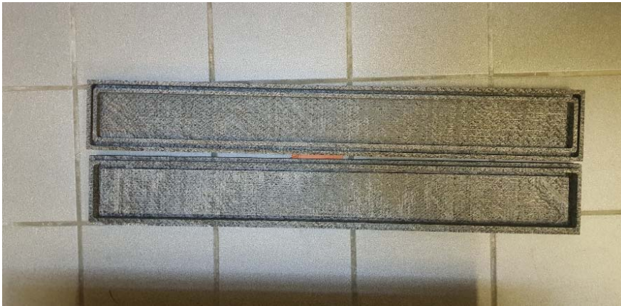
FIGURE B.1 – Barres de composites C/C usinées pour faire des cages de diffusion.
