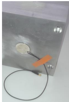
Figure 69 : Dispositif constitué de deux transducteurs piézoélectriques en PIC181 de 2.12 mm d'épaisseur et 45 mm de diamètre, collés alignés de part et d'autre d'une paroi en aluminium de 73 mm d'épaisseur.
