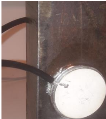
Figure 83 : Disque piézoélectrique de 45 mm de diamètre et épais de 2 mm en PIC18, collé sur un aimant placé avec du couplant acoustique sur une paroi ferromagnétique en acier épaisse de 55 mm.
