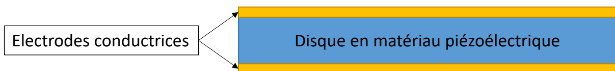
Figure 30 : Principe d'un transducteur piézoélectrique.
