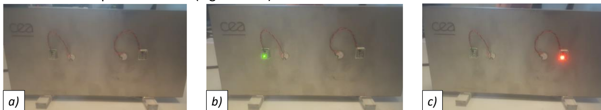
Figure 152 : Côté récepteur du démonstrateur lorsque les tensions sur les 7 électrodes de l'émetteur sont a) toutes en phases, b) optimisées pour focaliser les ondes mécaniques sur le récepteur de gauche, c) optimisées pour focaliser les ondes mécaniques sur le récepteur de droite.
