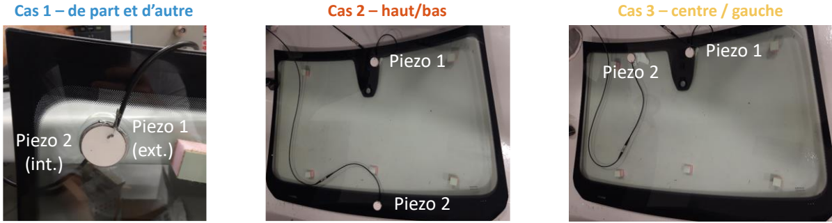
Figure 77 : Différentes configurations testées sans collage, pour évaluer les performances de TPA à travers un pare-brise.
