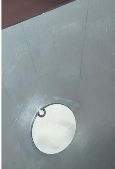
Figure 64 : Dispositif expérimental constitué de deux disques piézoélectriques en PIC181 de 2 mm d'épaisseur et de 45 mm de diamètre collés de part et d'autre d'une paroi en aluminium de 6 mm d'épaisseur.
