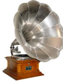
Figure 2 : Gramophone et son pavillon permettant d'augmenter la puissance acoustique transmise.
