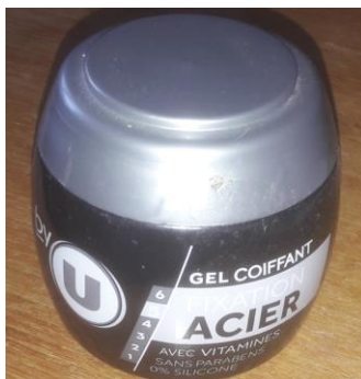
Figure 74 : Produit du commerce, dérivé de sa fonction première pour servir de couplant acoustique. Cette substance est peu chère, dédiée à l'acier et donne des performances comparables aux couplants acoustiques du commerce.
