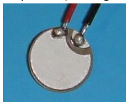
Figure 60 : Transducteur avec une électrode déportée. Les deux électrodes sont accessibles depuis un même côté rendant les connexions électriques plus faciles à réaliser.
