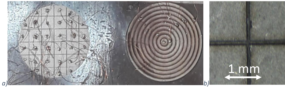
Figure 139 : a) Emetteurs gravés avec les motifs carrés à gauche et avec les motifs circulaires à droite. b) Zoom sur l'émetteur au motif carré.
