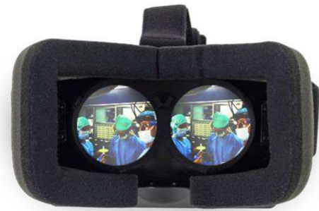
Figure 1 : vue des deux lentilles à l'intérieur d'un masque de réalité virtuelle : une image légèrement décalée est projetée sur chaque lentille, une pour chaque œil, permettant d'obtenir une vision dite stéréoscopique, 3D. Le film initial est enregistré à l'aide de deux caméras.
