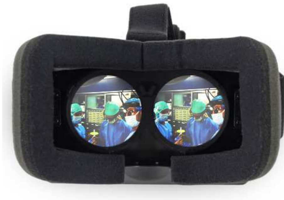
Fig. 5 : Vue des deux lentilles à l'intérieur d'un casque de réalité virtuelle. Une image légèrement décalée est projetée sur chaque lentille, une pour chaque œil, permettant d'obtenir une vision dite stéréoscopique, 3D. Le film initial est enregistré à l'aide de deux caméras.
