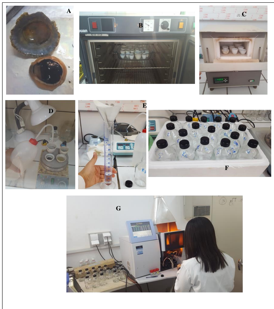
Figure 44 : Dosage des métaux (Préparation du matériel biologique (A : Partie molle séparée de la coquille, B : Séchage à l'étuve ; C : Calcination à 500°C ; D : Attaque acide ; E : Filtration ; F : Solutions filtrées à doser ; G : Dosage des métaux trace par absorption atomique)
