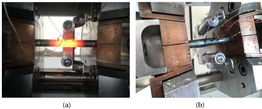
FIGURE 2.3 – Éprouvette pendant le traitement. (a) : maintien à 900°C. (b) : après la trempe.
