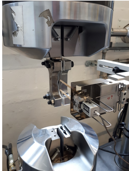
FIGURE 3.4 – Dispositif expérimental utilisé pour l’essai de traction cyclique en R = -1 .
