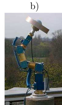
FIGURE 1.3 – Illustrations des calibrations relative (a) et absolue à l’aide d’un robot articulé (b).
