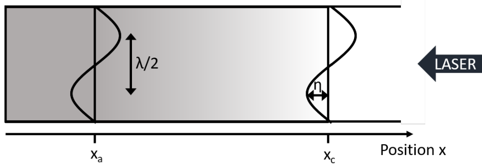
FIGURE IV.2: Schéma de la configuration perturbée. \lambda est la longueur d'onde de la modulation et \eta son amplitude.
