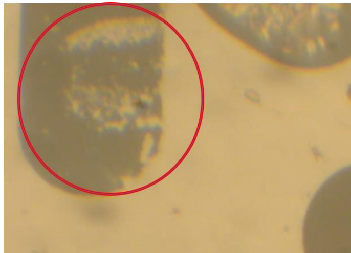
Figure VI-18 : Détérioration des électrodes de séparation
