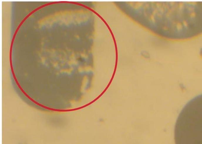
Figure VI-18 : Détérioration des électrodes de séparation
