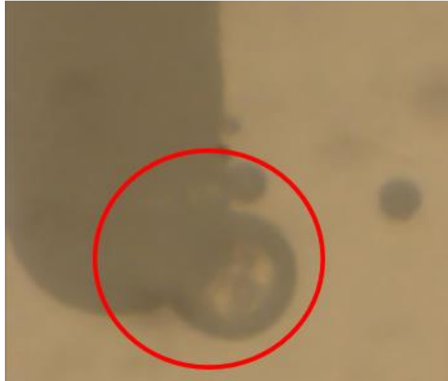
Figure VI-17 : Dégagement gazeux au niveau des électrodes de séparation par diélectrophorèse
