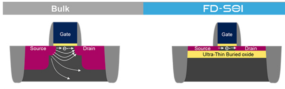
FIGURE 4 – Comparaison des technologies Bulk et FD-SOI [58]
