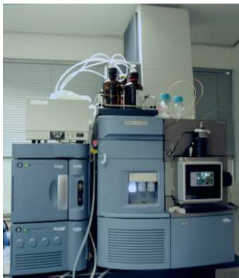
Figure 50 : Système Acquity UPLC H-Class (Waters, Milford, USA) couplé au spectromètre de masse Xevo G2 S Q-TOF, présent sur la plateforme d'Analyse Haute Résolution de Biomolécules du laboratoire LIENSs
