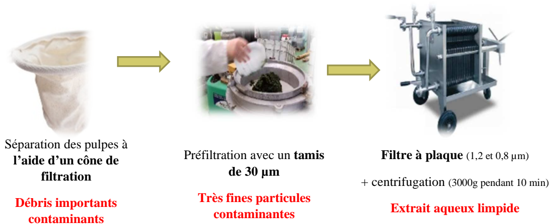
Figure 64: Récapitulatif des étapes de préfiltration mises en place afin d'optimiser la filtration du procédé Seprosys (cône de filtration, étape de préfiltration à l'aide d'un tamis de 30 \mu\text{m} et d'un filtre à plaque)
