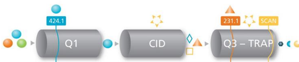
Figure 13 : Schéma de fonctionnement de l'acquisition par MRM 3 (source : Sciex®)
