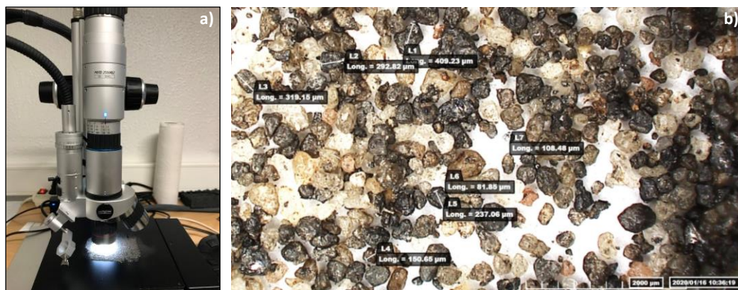
Figure II.7 : Microscope optique (HIROX) et exemple de mesure des dimensions des particules aimantées
