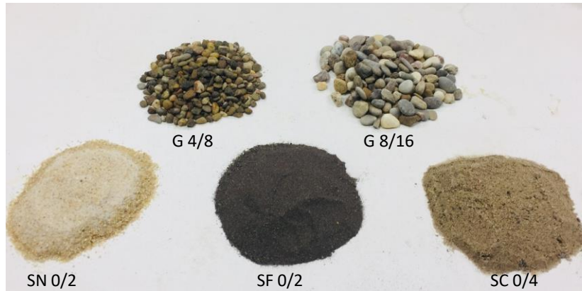
Figure II.1 : Granulats utilisés dans la fabrication des mortiers et bétons (SN : sable normalisé, SF : sable de fonderie, SC : sable de construction, G : gravillon)
