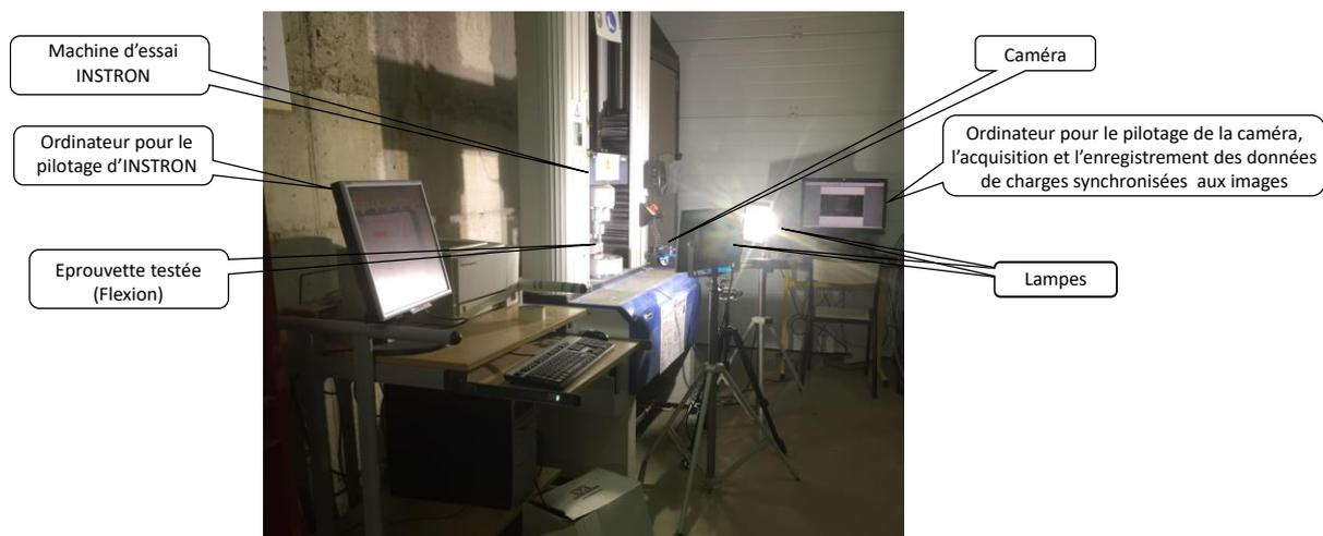
Figure II.9 : Installation pour un essai de flexion couplé à la CIN
