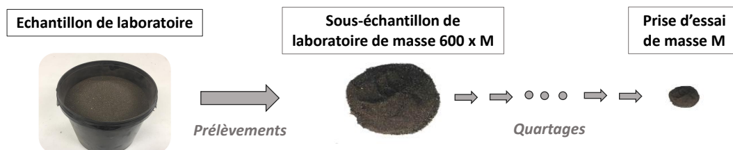
Figure II.3 : Préparation des prises d'essai pour les essais supplémentaires de caractérisation physico-chimique des sables
