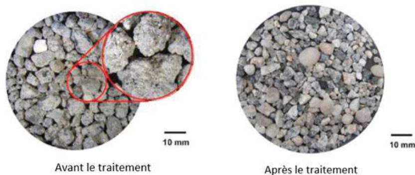
Figure 2. GBR avant et après le traitement avec 33 % HCl. Extrait et modifié de [19]
