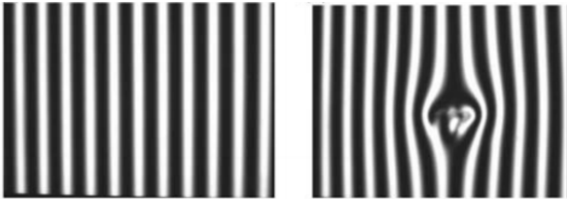
FIGURE 1.8 – Motifs de franges réfléchies à partir d'une surface plane à gauche et d'une surface non plane à droite [54]
