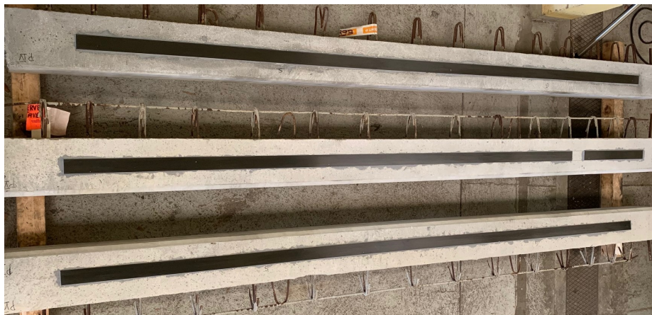
FIGURE 2.4 – Assemblages collés béton-composite poutre : BC-Po
