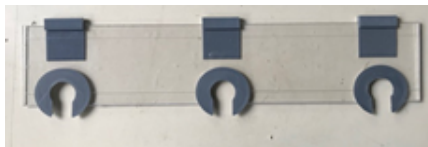
FIGURE 2.18 – Règle imprimée en 3D utilisée pour conserver une disposition des capteurs identique
