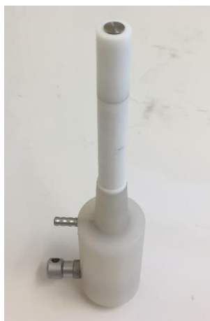
Figure 22. Tête de l'électrode à disque tournant en acier inoxydable riche en Si.
