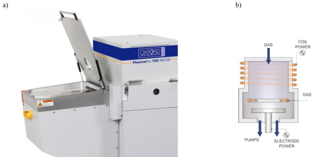
*Figure III.2 : L'équipement utilisé pour le dépôt de couches de transport d'électrons.*
